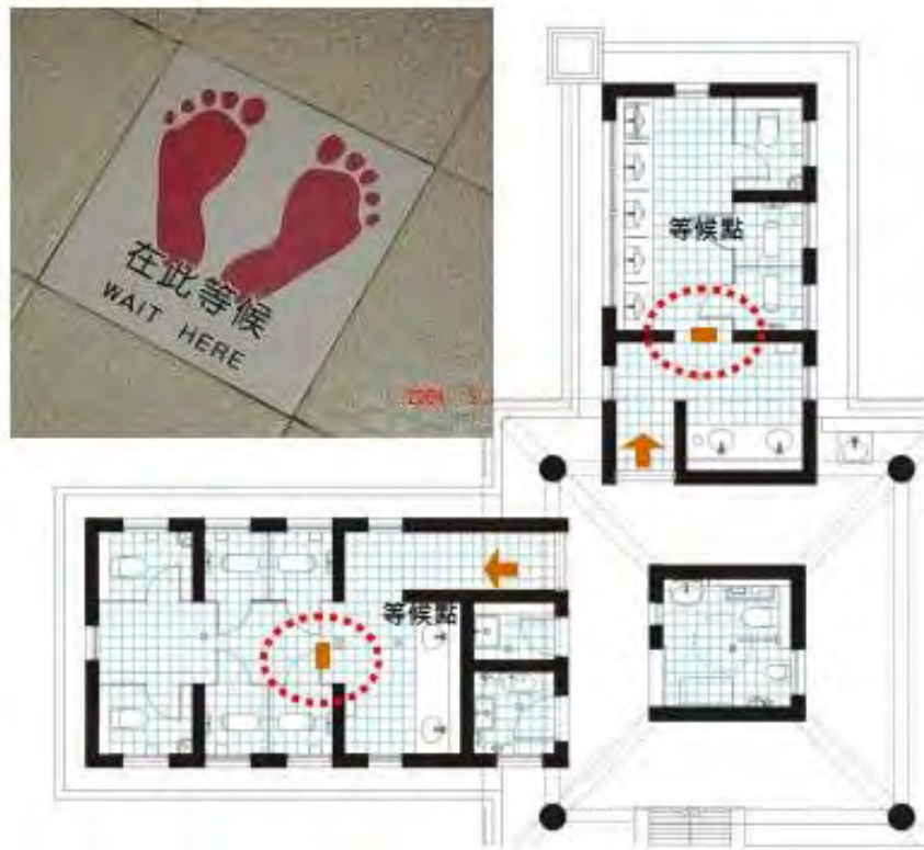
標示等候線地磚之案例 (二二八公園公廁)
